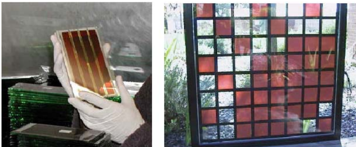
Figura I.1. Aplicación de las celdas de Grätzel insertadas a la arquitectura del entorno. Tomada de [15].
