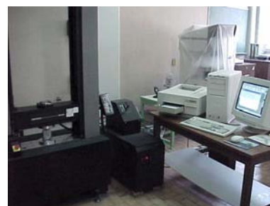
Figura 4. Máquina Universal y sistema de adquisición de datos utilizados en las pruebas de adhesión por corte compresivo (IIE, Temixco, México).
