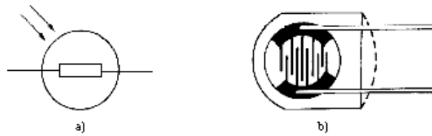
Figura 2.23 Fotorresistencia (LDR). a) Símbolo. b) Modelo de bajo costo, encapsulado en plástico transparente
